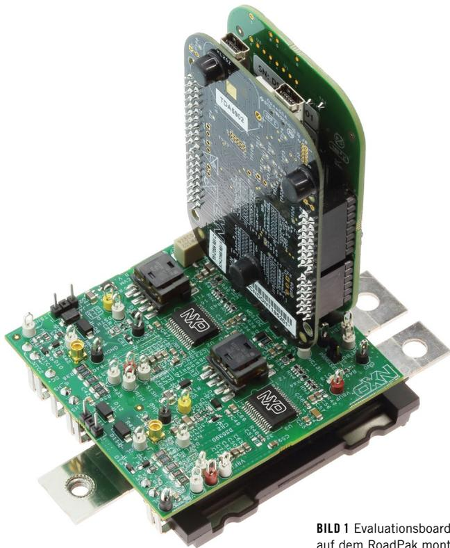
**BILD 1** Evaluationsboard mit Gate Unit auf dem RoadPak montiert (© NXP)
