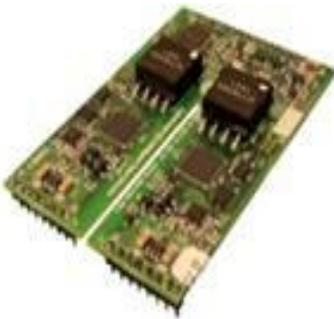
Der neue Treiberkern von AgileSwitch ist optimiert für 1.200V und 1.700V SiC-MOSFETs.
