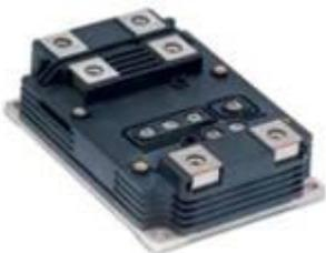
ABB stellt eine 1.700V SiC-MOSFET-Halbbrücke im LinPak vor. Dies besonders niederinduktive Modul hat einen typischen  $R_{DSon}$  von weniger als 3mOhm und kann bis zu 2x1.100A liefern.
