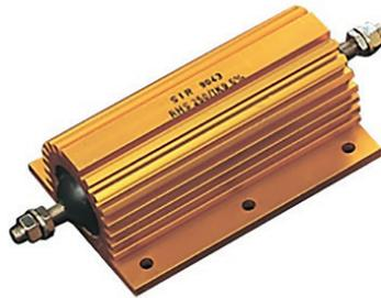
I resistori RHS presentano una ampia gamma di valori resistivi, da 0,05  $\Omega$  fino a 82 k $\Omega$ , il range dei valori di potenza varia da 10 W a 300 W, fino a 600 W per i resistori con raffreddamento ad acqua.
